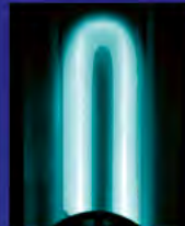
Hybrid HiPIMS / rf plasma using an aluminum target. Fraunhofer-Institut für Werkstoffmechanik IWM Wöhlerstraße 11, 79108 Freiburg
